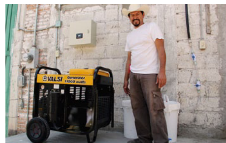
Uno de los ganaderos usando un motor de gasolina modificado para funcionar con biogás
