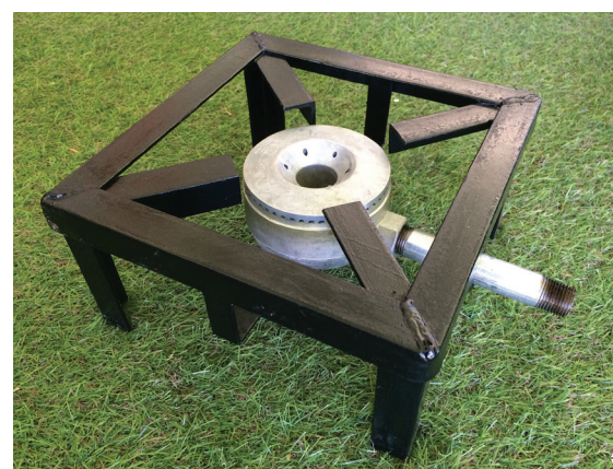
Figura 3. Estufa a biogás sin inyección del biogás, con eliminación de ingreso de aire primario.
