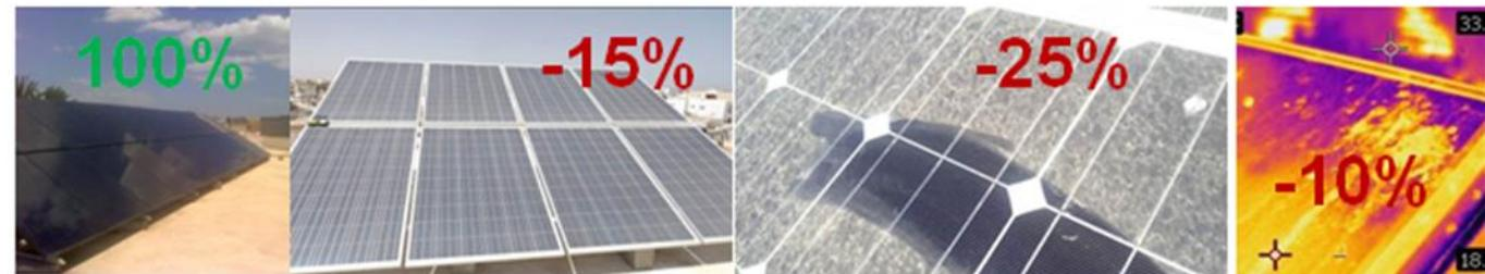
FIGURE 27 : EXEMPLES D'ENCRASSEMENT ET DE PERTES DE PUISSANCES ASSOCIEES
