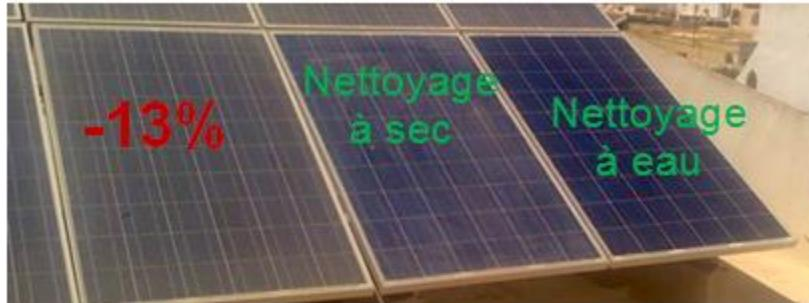
FIGURE 28: TESTS DE NETTOYAGE
