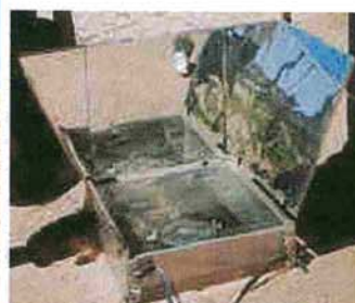
Foto 2 Fogão tipo "caixa quente", produto artesanal
