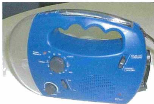
Foto 11 Rádio solar: painel fotovoltaico (em cima) com pequena lanterna (lado esquerdo) e microgerador manual (ao lado direito)
