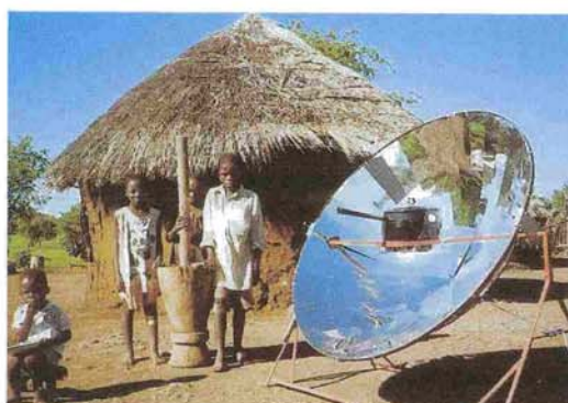
Foto 1 Fogão solar de reflector parabólico fabricado na Zimbabwe
