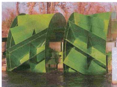
Foto 27 Turbina hídrica tipo "SDM" de 150 kW
