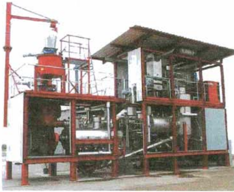
Foto 32 Gaseificador de biomassa com gerador a gás de 125 kW
