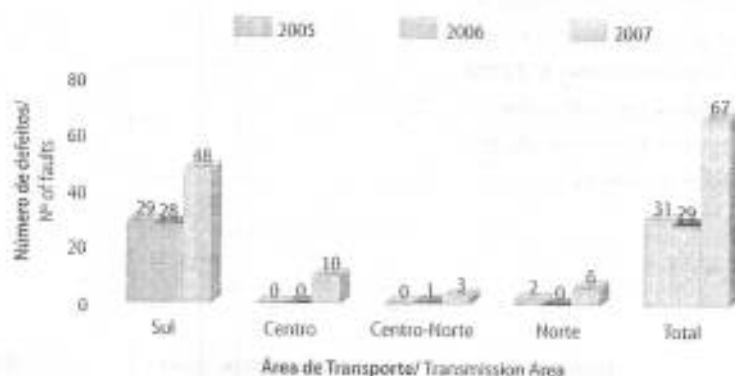
FIGURA 42: Comparação dos disparos dos transformadores Comparison of transformers trippings
