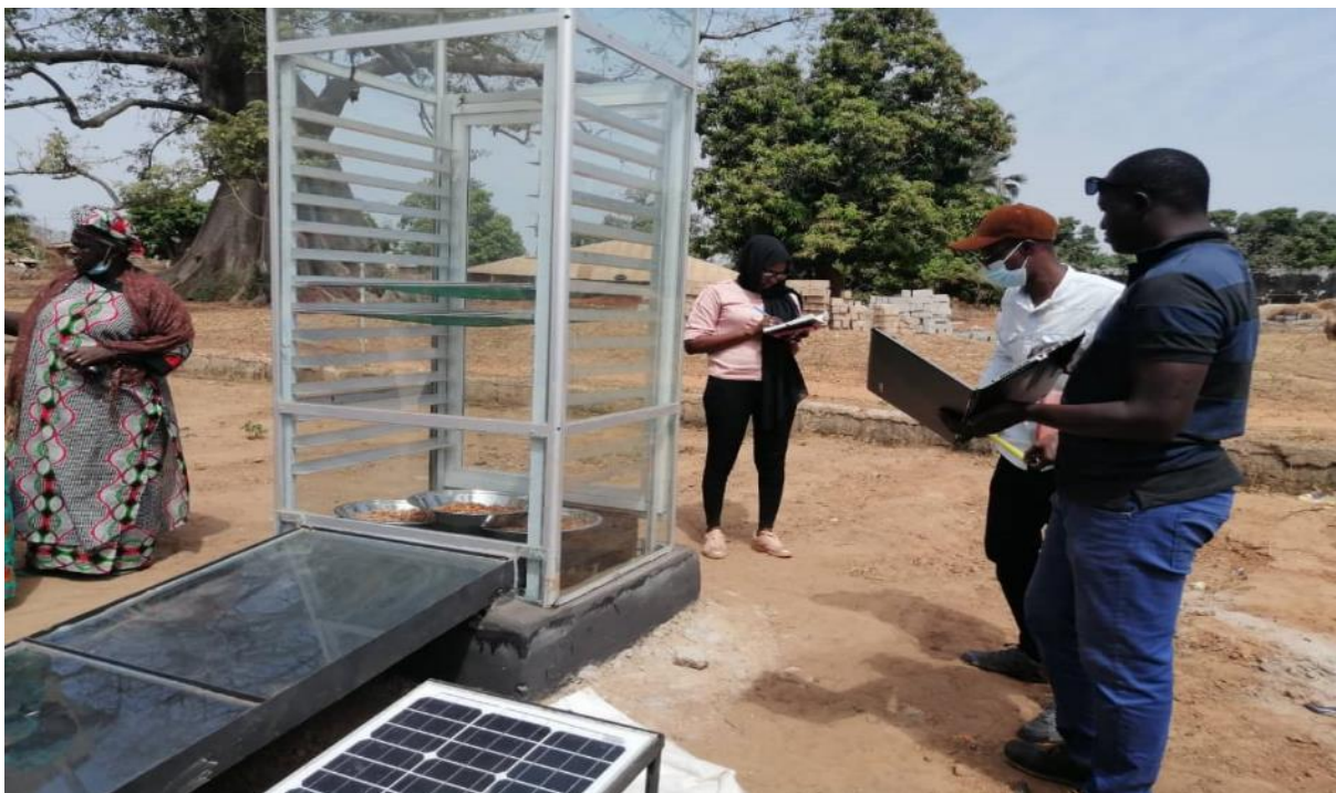
Figure 2 : Le séchoir solaire (chambre de séchage, capteur et module PV
