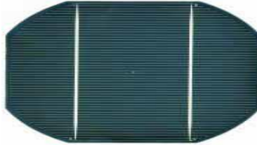
Figura 2: Ilustração duma célula de silício monocristalino
