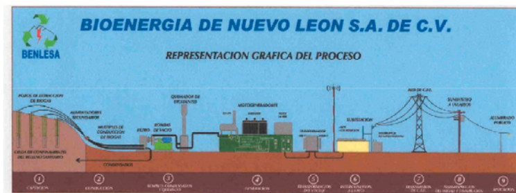
Figura 78. Aprovechamiento energético de biogás proveniente de un relleno sanitario (BENLESA, Nuevo León).
