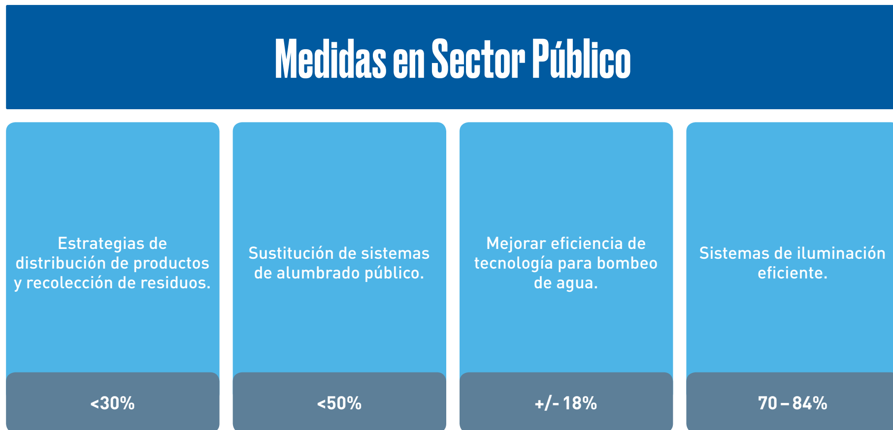
Figura 97. Medidas potenciales de eficiencia energética para el sector público y su porcentaje de ahorro energético.
