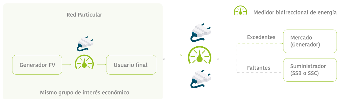
FIGURA 18: ESQUEMA DE ABASTO AISLADO
