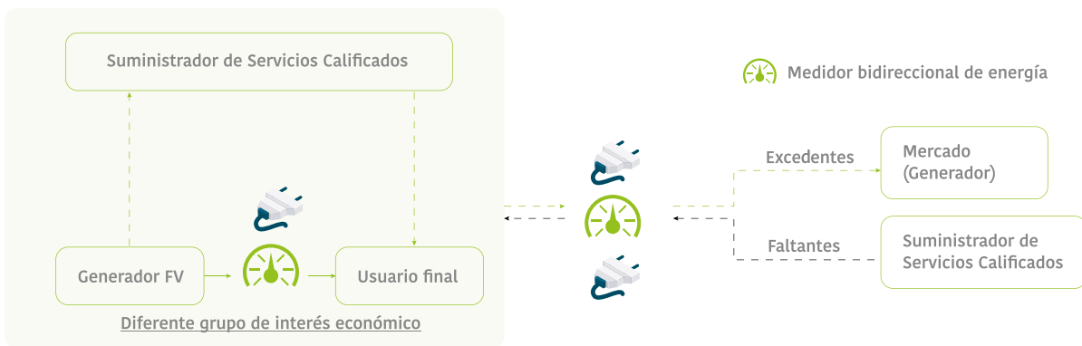
FIGURA 20: ESQUEMA DE GENERACIÓN LOCAL
