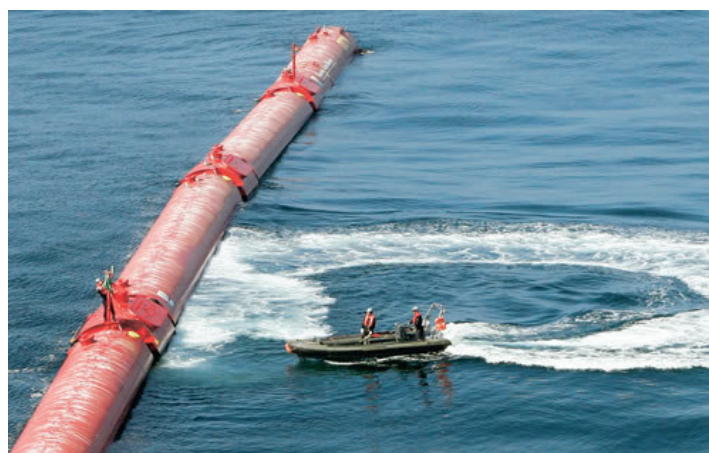
Figura 3: Imagem da central de conversão de energia de onda em electricidade que pode iluminar seis mil residências na costa de Portugal.
