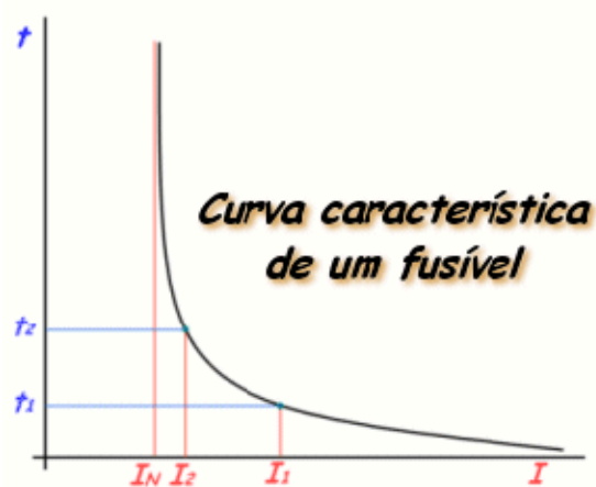
Fig. 8: Ilustração da curva característica de um fusível
