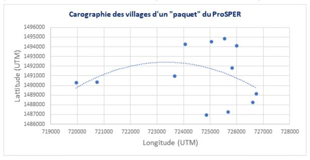
La centrale sera placée au barycentre des villages de façon à équilibrer la répartition de la puissance au niveau de chaque village. Les transformateurs abaisseurs de tension seront dans la mesure du possible partagés entre 4 villages au maximum avec une cellule de départ T4-800 en triphasé ou en monophasé selon la demande.
