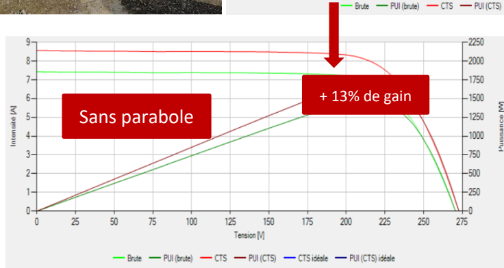
Figure 31: problème d'ombrage - parabole
