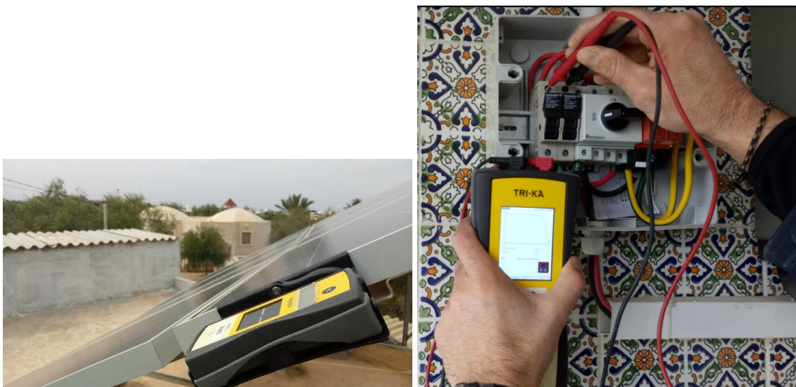
Figure 8: utilisation du traceur de courbe I(V)
